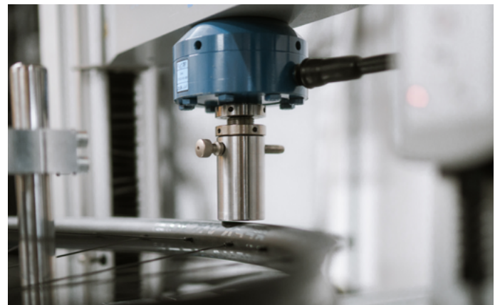
seitliche Belastung für das Laufrad
