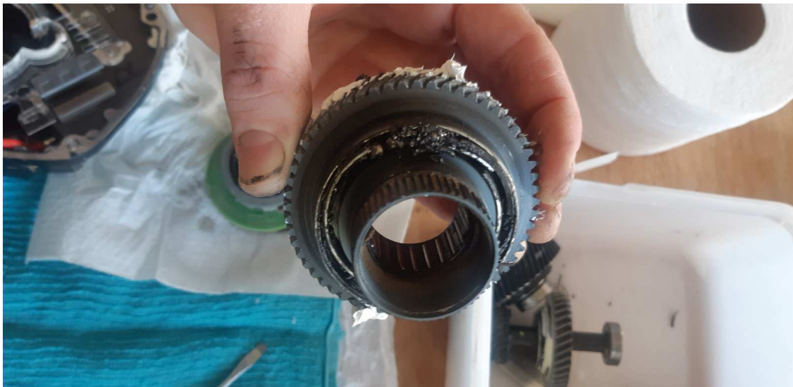
Beschädigtes Lager und darunter das beschädigte Lagergehäuse im Motorgehäuse
