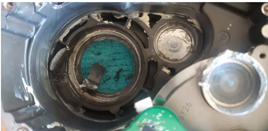
Beschädigtes Lager und darunter das beschädigte Lagergehäuse im Motorgehäuse
