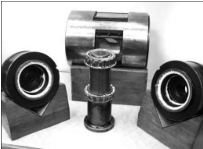
Welle mit zerlegten Prüflagern, Außenringen, Lagerschalen und Schauglas
