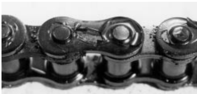
Verlackungen durch hohe Temperatur an einer Prüfkette
